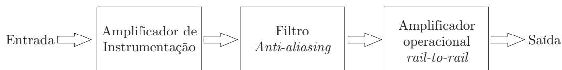
Figura 4.3: Diagrama de blocos representando as etapas do circuito de condicionamento de sinal.
